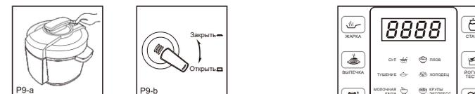
7. В процессе нагрева скороварки, индикатор «Нагрев» мигает, а по достижении заданного рабочего давления, цифровой индикатор отображает оставшееся время поддержания давления в режиме обратного отсчета, после чего скороварка переходит в режим подогрева и загорается индикатор «Подогрев».
