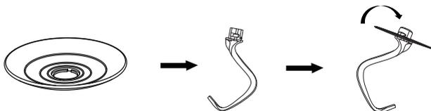
Рис. 1-1: Зафиксируйте пылезащитную крышку по часовой стрелке
