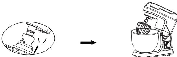
Рис. 2-2: Установите лопатку для перемешивания, закройте чашу крышкой и одновременно установите насадку в горизонтальное положение.
