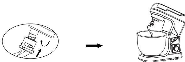
Рис. 1-3: Установите лопатку для замешивания теста, закройте чашу крышкой и одновременно установите насадку в горизонтальное положение.
