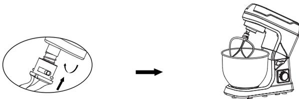
Рис. 2-2: Установите лопатку для перемешивания, закройте чашу крышкой и одновременно установите насадку в горизонтальное положение.
