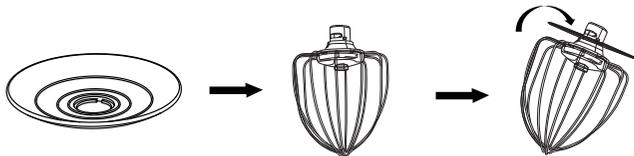
Рис. 3-1: Зафиксируйте пылезащитную крышку по часовой стрелке
