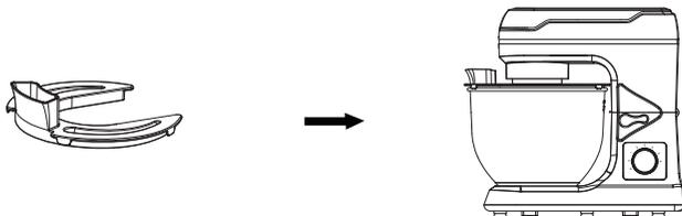
Рис. 1-4: Установите лопатку для замешивания теста, закройте чашу крышкой и одновременно установите насадку в горизонтальное положение.
